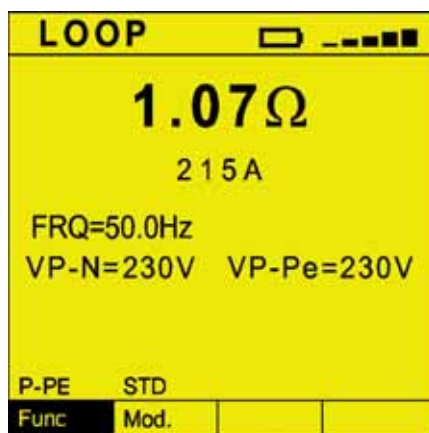
Rys. 7. Pomiar dużym prądem impedancji pętli przewodów fazowy-przewód ochronny
