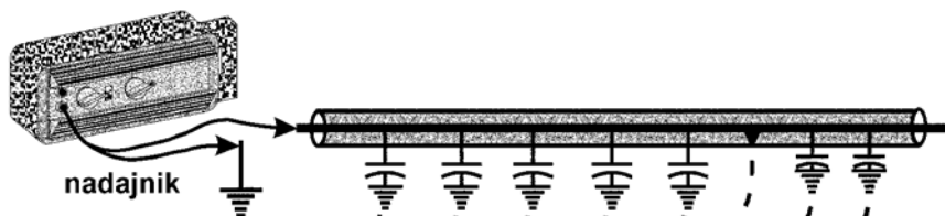
Rys. 5. Pętla pomiarowa przy braku połączenia końca obiektu z ziemią
