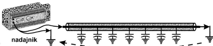
Rys. 1 Uziemienie przeciwnego końca obiektu
