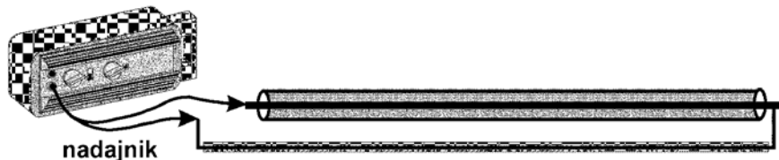
Rys. 6. Zamknięcie pętli pomiarowej przewodem w izolacji
