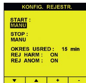
Rys. 9 Menu konfiguracji rejestratora (nastawy czasu)
