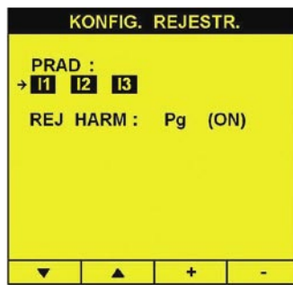
Rys. 11 Menu konfiguracji rejestratora (nastawy prądu)
