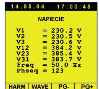
Rys. 13 Przykład ekranu miernika w trybie pracy „miernik” przy pomiarze napięcia w układzie trójfazowym czteroprzewodowym: V 1 – napięcie fazy L 1 , V 12 – napięcie międzyfazowe, freq – częstotliwość, Phseq – informacja o kierunku wirowania faz
