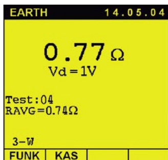
Rys. 7 Przykład ekranu miernika podczas wielokrotnego pomiaru rezystancji uziemienia: V_d – napięcie zakłócające, R_{AVG} – rezystancja średnia obliczona na podstawie pomiarów, których liczba jest wyświetlana
