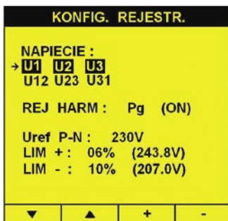
Rys. 10 Menu konfiguracji rejestratora (nastawy napięcia)
