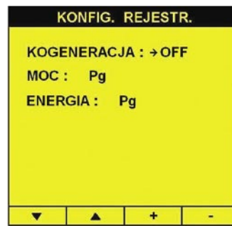
Rys. 12 Menu konfiguracji rejestratora (nastawy mocy i energii)
