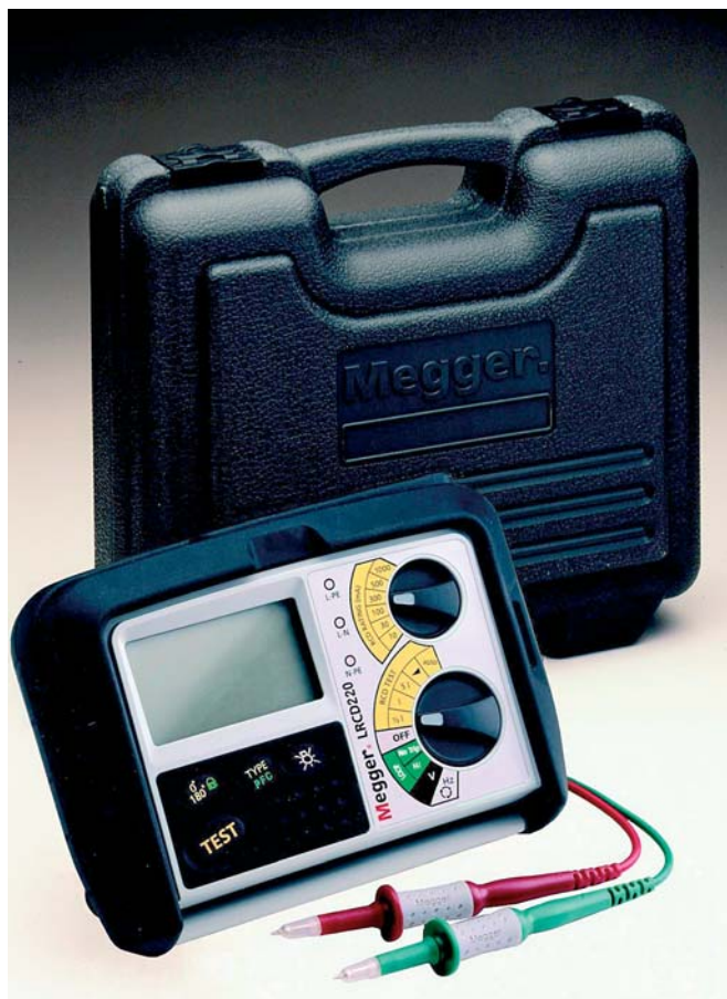
Rys. 5. Miernik Megger LRCD220 z walizką z tworzywa
