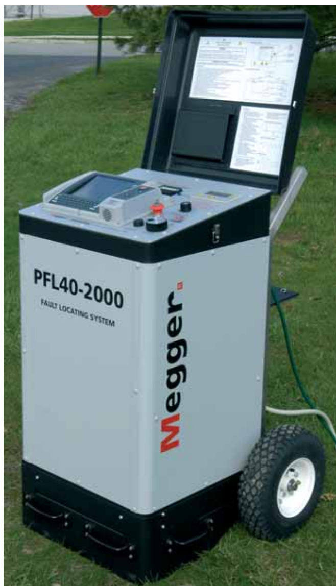
Rys. 2. System pomiarowy Megger PFL40A
