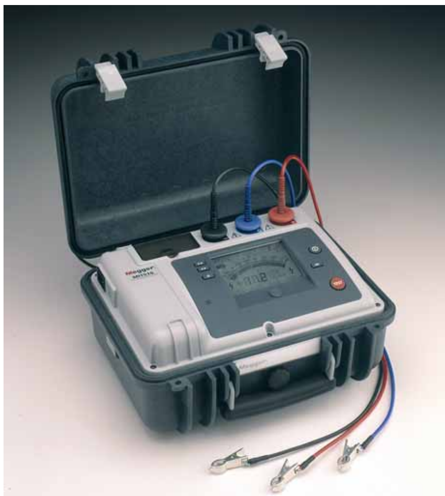
Rys. 1. Miernik Megger MIT510
