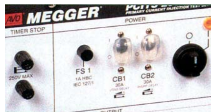
Rys. 4. Zabezpieczenia układów wyjściowych wymuszalnika PCITS2000/2
