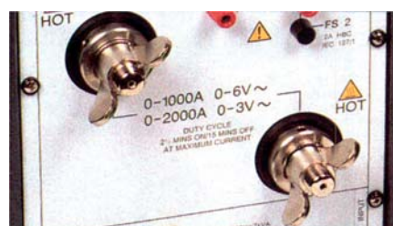
Rys. 5. Nakrętki motylkowe na zaciskach prądowych wymuszalnika PCITS2000/2
