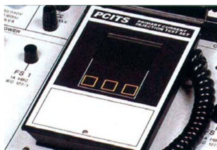
Rys. 6. Moduł zdalnego sterowania wymuszalnika PCITS2000/2
