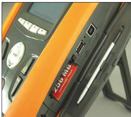
Rys. 11. Gniazda wyjściowe analizatora
