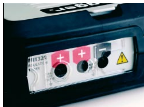
Rys. 3. Zabezpieczenie przed nieprawidłowym podłączeniem przewodów pomiarowych
