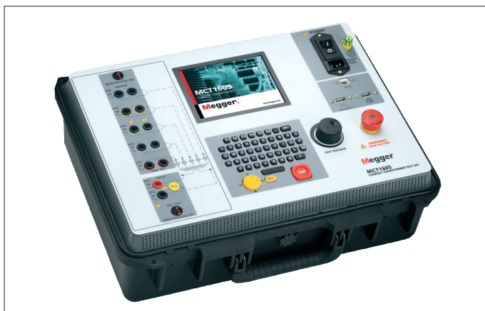
Fot. 3 Miernik przekładników prądowych Megger MCT1605
